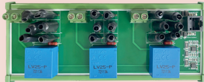
电压测量单元，量程可选为 \pm 1000V ， \pm 500V ， \pm 250V ， \pm 100V 。 详情见第 46 页
